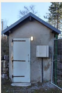
Afin de contrôler le bon fonctionnement des pompes de relevage qui alimentent la réserve d'eau de Lesdiguières et des Amars, la municipalité a mis en place un système d'alerte. Ce dernier est constitué d'un témoin lumineux équipé de LED basse consommation implanté sur le local des pompes. Lorsque le témoin est allumé, il permet à tout un chacun de vérifier que les pompes fonctionnent correctement. Dans le cas contraire, veuillez prévenir la mairie ou Monsieur le maire
